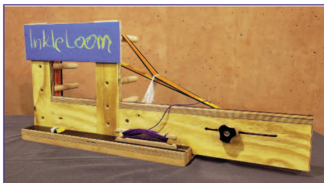
Zu sehen sind: der Sterngriff zum Verstellen des Spannzylinders, die Aufbewahrungsnut für das Schiffchen und die Namenstafel
