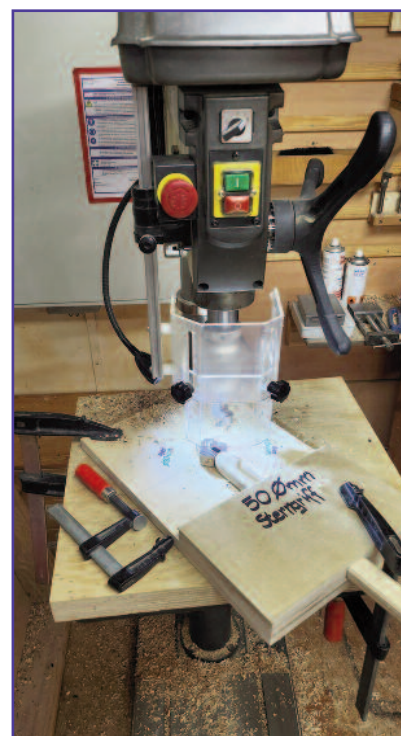
Die einzelnen Schritte zum Sterngriff und die Sterngriff-Vorrichtung an der Bohrmaschine
