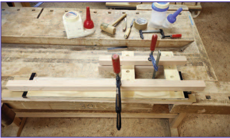
Verleimvorgang mit Lamellenverbindung des Grundrahmens
