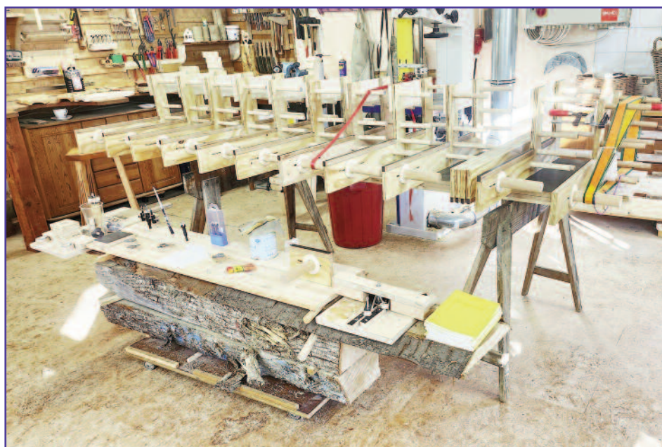
Die einzelnen Schritte zum Sterngriff und die Sterngriff-Vorrichtung an der Bohrmaschine
